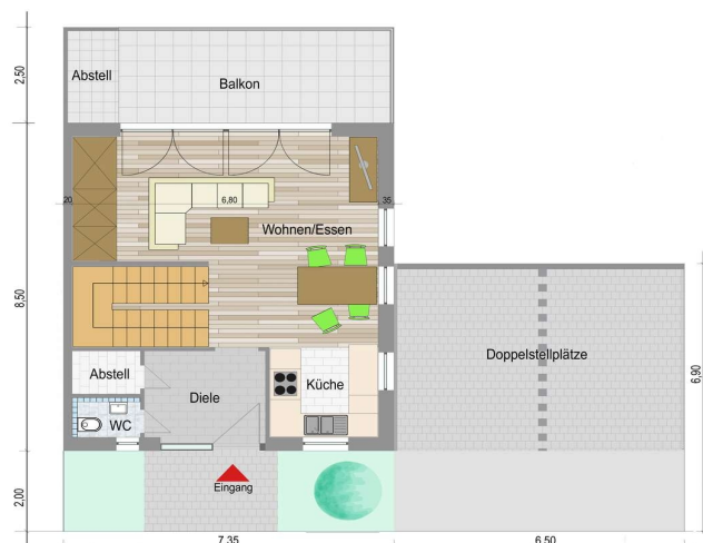
Objekt Altensteig, Amselweg Grundriss Erdgeschoss
